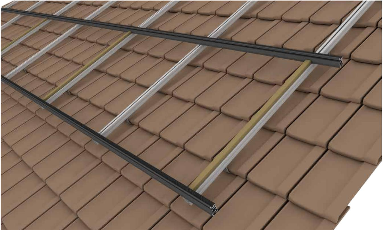
Oberster „LAYUP Träger“ um 180° gedreht mit Distanzholz (22mm kürzer) montieren.
